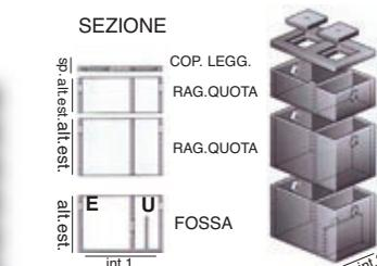
**SCHEMA DI MONTAGGIO ED UTILIZZO DEGRASSATORE**
